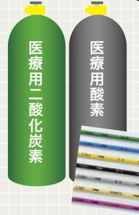
高圧ガス保安法に基づく二酸化炭素ガスボンベ(左)と酸素ガスボンベ(右)と医療ガス配管(下)。ボンベの色は、ガスの種類により決められています。※イラストのボンベはイメージです。
